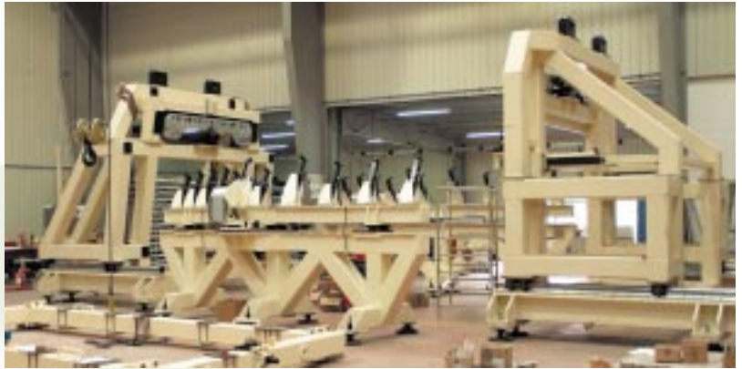
Bâti d'assemblage barque avant A380.
