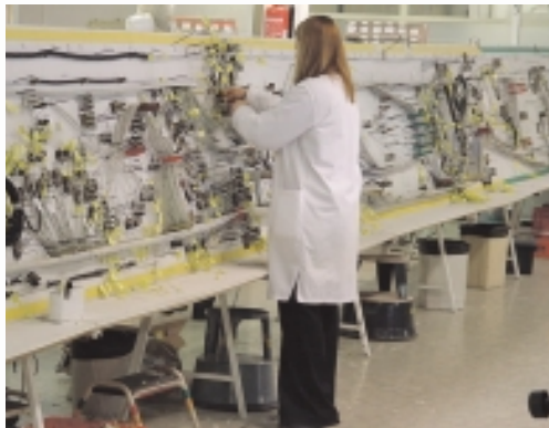
Câblage harnais 10 VU A320 au Cres
