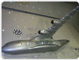
> Mesure de déformée de voilure en soufflerie pour l'ONERA > Wing deformation measurement in a wind tunnel for ONERA
