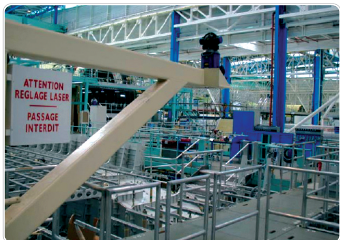
→ Assemblage par la mesure - Pilotage par laser Tracker → Assembly by measurement - Control by Tracker laser
